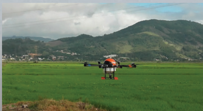
Aplicação de herbicidas realizada com drone dotado de barras de aplicação de cinco metros de largura
